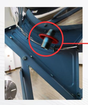
Ao utilizar o "Pescador" para o acoplado a vácuo, ele deve ser instalado na saída da parte inferior do reservatório.
